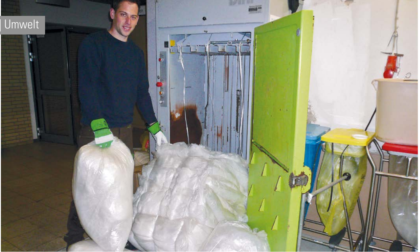
Sortenreiner Kunststoff wird zu Ballen gepresst und zur Wiederverwertung an entsprechende Firmen weitergegeben.
